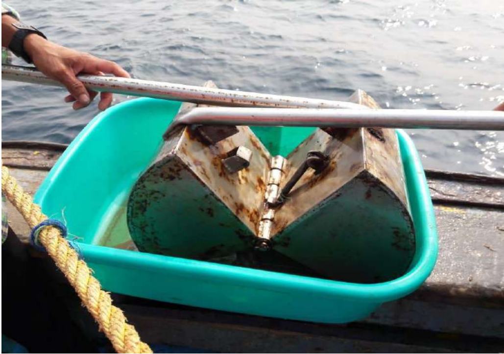
Fig. 3.3: Van Veen Grab Sampler
